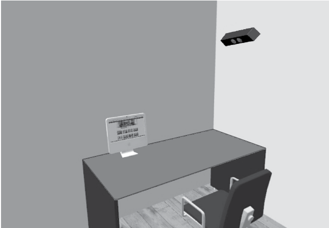
The device is placed above the desk at a height of 1.5 m, the slope angle: about 45° / Urządzenie jest umieszczone nad biurkiem na wysokości 1,5 m, kąt pracy: ok. 45°.
