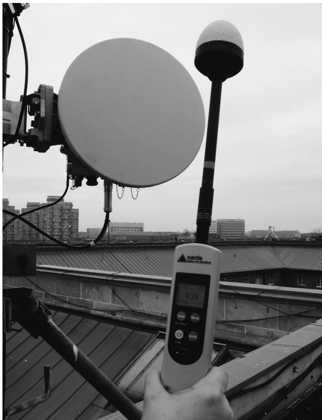
Pasmo E – pasmo telekomunikacyjne o szerokości 10 GHz (71–76 GHz oraz 81–86 GHz) / E band – telecommunications bandwidth of 10 GHz (71–76 GHz and 81–86 GHz).
